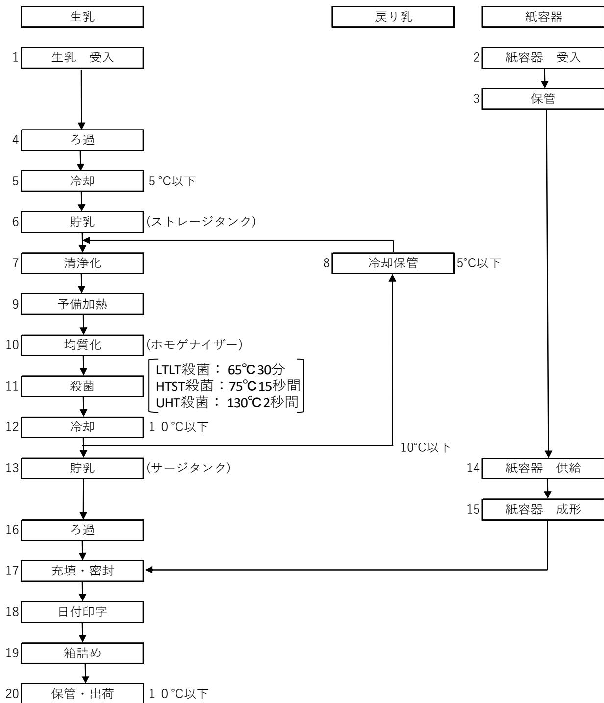
※ 上記製造工程図は一例です。工程図を作成する場合は、各事業者の実工程、工程条件に合わせてください。戻り乳を添加する場合は、生乳に直接添加し長時間保持されるとリバーゼの酵素反応により、ランシッド臭が発生する恐れがあります。戻し乳の添加場所は、殺菌まで短時間となる箇所に設置してください。
