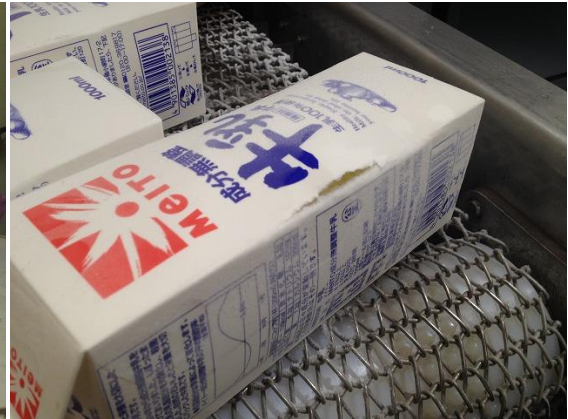
凍結後の破損
