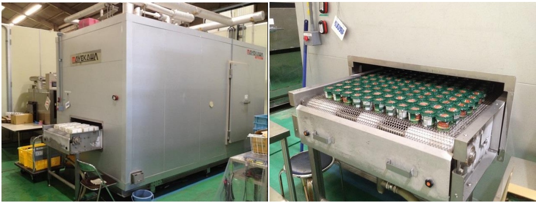
図 1. 急速凍結に使用したサーモジャックフリーザー
