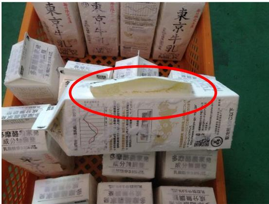
図 19. A1-PA の容器の破損
