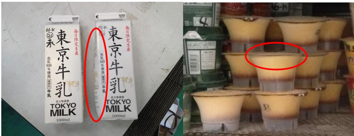
図 14. A1-K の膨張 左:未凍結品 図 15. A5-K ふたの膨張
