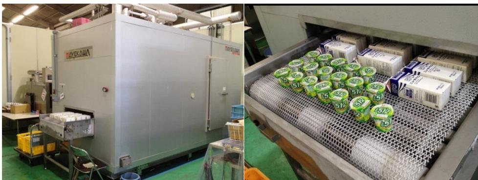
図 3. 急速凍結に使用したサーモジャックフリーザー
