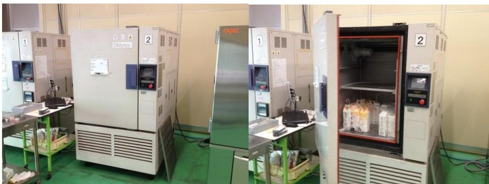
図 2. 緩慢凍結に使用した恒温機
